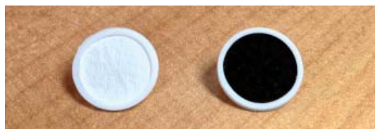
Filtre propre (gauche) et filtre après échantillonnage (droite)
