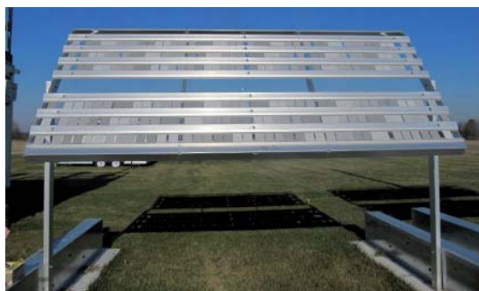
Banc d'essai de Sainte-Anne-de-Bellevue avec plaques témoins Photo courtoisie de l'IREQ (Hydro-Québec), 2012
